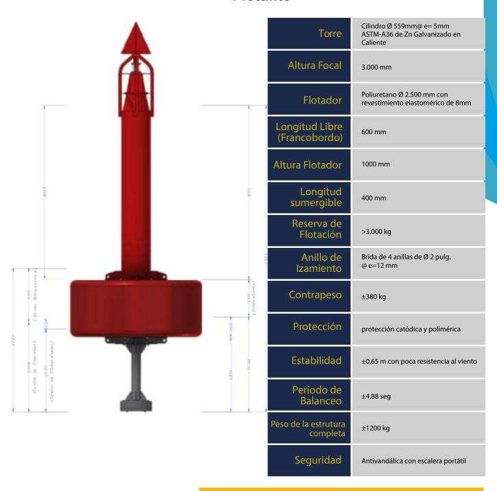
Flotador con revestimiento elastomérico para superprotección a Rayos UV y cizallamiento por impacto.
